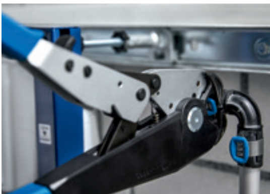
Ručni alat za stiskanje pokriva pet dimezija i ne zahteva ni struju ni punjive baterije.
